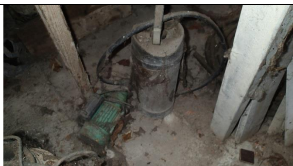
43. Pumpe za žbukanje PFT-G4 – neispravni, vitalni dijelovi su zapekli i korodirali.
