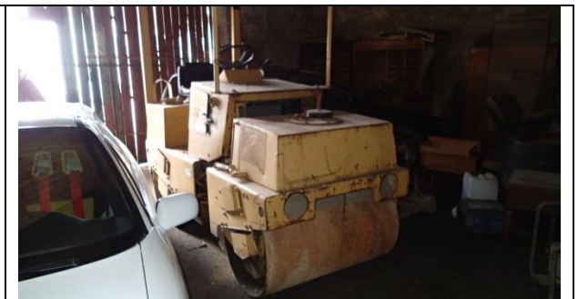
36. Vibro valjak Dynapac CC10 – valjak je neispravan, zbog dugog stajanja i općeg stanja upitno je dali je isplativ popravak.
