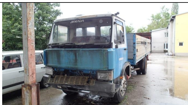
39. Kamion Iveco 109.14.1 – neispravan, derutan , vitalni dijelovi su zahvaćeni korozijom.
