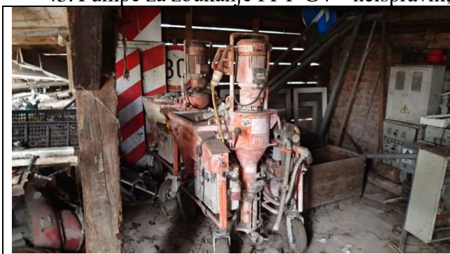
43. Pumpe za žbukanje PFT-G4 – neispravni, vitalni dijelovi su zapekli i korodirali.
