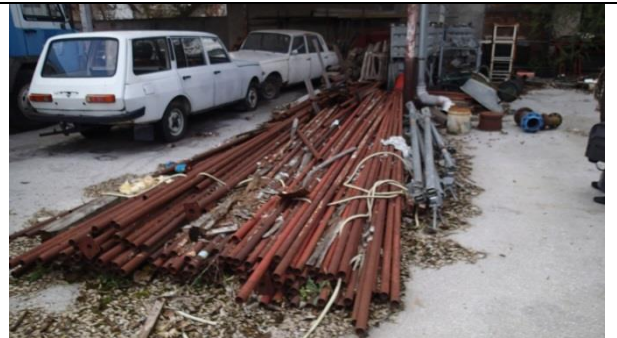
38. Elementi montažne skele Doka – elementi su razbacani desortirani, cijevi su korodirane , ima dosta savijenih i oštećenih.
