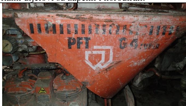
43. Pumpe za žbukanje PFT-G4 – neispravni, vitalni dijelovi su zapekli i korodirali.
