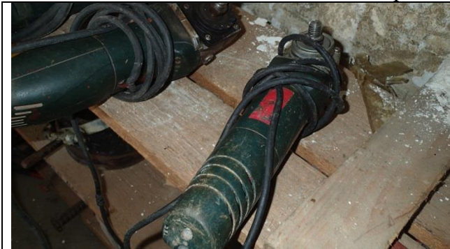
57. Mala kutna brusilica Metabo – neispravna i oštećena
